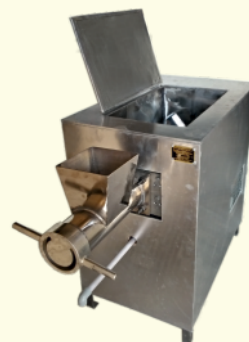
Flour Kneading & Sheet Maker Machine (Combine Machine) कम्बाइन मशीन
